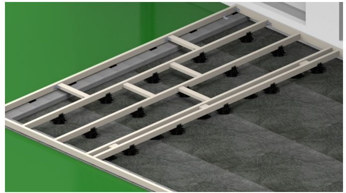
13. Danach wird der 2 Balken inkl. der Verstellfüße an die 3 kurzen Balken angeschraubt. Die Verstellfüße müssen versetzt angeordnet werden.
