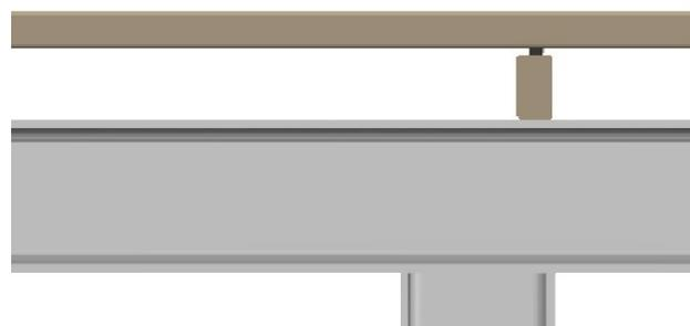
Die Verschraubung der 38 x 140 mm Kebony Clear Dielen erfolgt mit einer 5 x 80 V2A-Schraube, wodurch die erforderliche Einschraubtiefe in der Unterkonstruktion von min.  $6 \times d$  sichergestellt wird. Bei öffentlichen Objekten sollte eine 6 mm Terrassenschraube verwendet werden.
