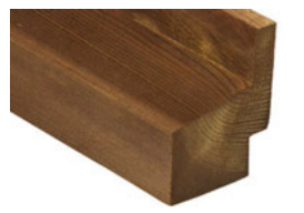
1217 Kebony Character Rhombusprofil Melsom · 61 x 48 mm Deckbreite: ~ 47 mm* Einsatz für geschlossene be- oder hinterlüftete Fassaden Montage: horizontal, sichtbar verschraubt
