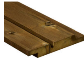
2596 Kebony Character Doppelprofil mit Wechselfalz 75** · 21 x 148 mm Deckbreite: ~ 128 mm* Einsatz für geschlossene be- oder hinterlüftete Fassaden Montage: vertikal und horizontal, sichtbar verschraubt
