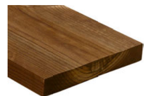
1243 Kebony Character Fassadenholz · 21 x 148 mm Deckbreite: ~ 148 mm* Einsatz: z. B. als Boden-Deckel-Schalung Montage: vertikal, sichtbar verschraubt
