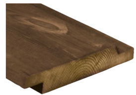
2594 Kebony Character Wechselfalzprofil 75** · 21 x 148 mm Deckbreite: ~ 128 mm* Einsatz für geschlossene be- oder hinterlüftete Fassaden Montage: vertikal und horizontal, sichtbar verschraubt
