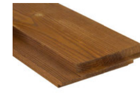
2651 Kebony Character Wechselprofil 75° ** · 21 x 98 mm Deckbreite: ~ 77 mm* Einsatz für geschlossene be- oder hinterlüftete Fassaden Montage: vertikal und horizontal, sichtbar verschraubt
