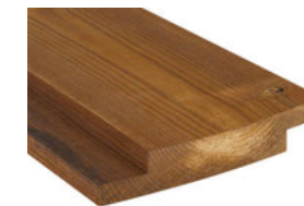
2649 Kebony Character Wechselprofil 75° ** · 21 x 123 mm Deckbreite: ~ 103 mm* Einsatz für geschlossene be- oder hinterlüftete Fassaden Montage: vertikal und horizontal, sichtbar verschraubt
