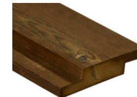
2378 Kebony Character Wechselprofil 90° ** · 21 x 98 mm Deckbreite: ~ 78 mm Einsatz für geschlossene be- oder hinterlüftete Fassaden Montage: vertikal, sichtbar verschraubt
