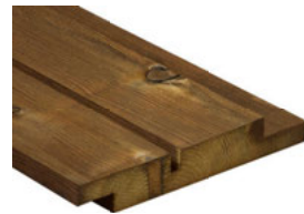
2339 Kebony Character Doppelwechselfalzprofil 90°** · 21 x 148 mm Deckbreite: ~ 131 mm* Einsatz für geschlossene be- oder hinterlüftete Fassaden Montage: vertikal, sichtbar verschraubt
