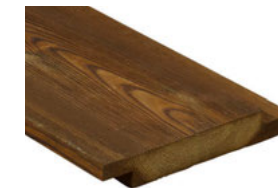
2216 Kebony Character Wechselprofil 90° ** · 21 x 148 mm Deckbreite: ~ 128 mm* Einsatz für geschlossene be- oder hinterlüftete Fassaden Montage: vertikal, sichtbar verschraubt
