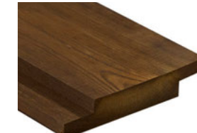
2380 Kebony Character Wechselprofil 90° ** · 21 x 123 mm Deckbreite: ~ 103 mm* Einsatz für geschlossene be- oder hinterlüftete Fassaden Montage: vertikal, sichtbar verschraubt
